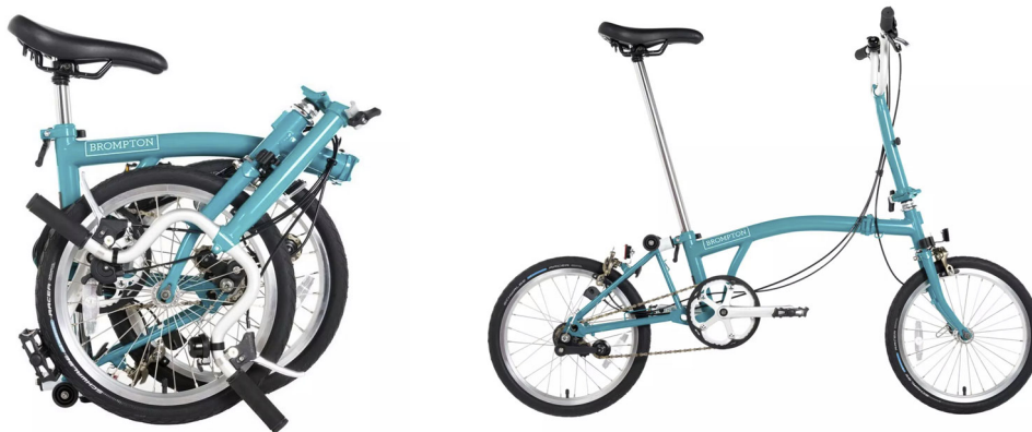
Abbildung 12 Zustände Brompton Faltrad: Zusammengefaltet und fahrbereit
