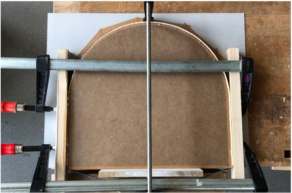
Durch die Formverleimung von Eschenfurnier gelang es die Federstahl- mit Eschenholzbögen zu ersetzen. Dies war ein wichtiger Meilenstein, denn somit gelang es den ganzen Rahmen aus Eschenholz zu fertigen und damit das Gewicht des Objektes zu verringern. Die Spannkraft der Eschenbögen war zusätzlich stärker und verkrachten im Vergleich zu den Federstahlbögen weder Decke noch Boden.
