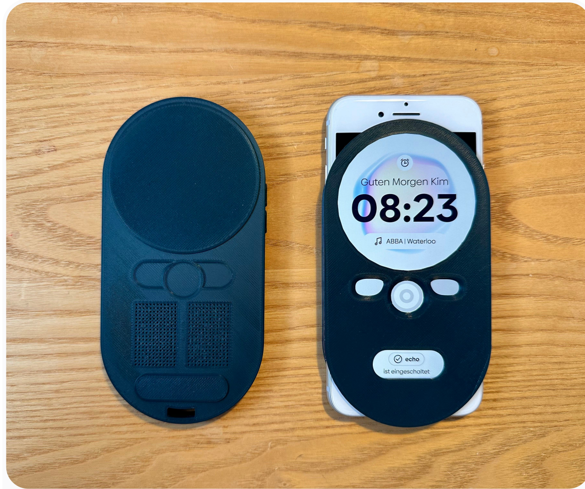
Testdruck (3D-Drucker) für die Hülle und Konzept für die echo one als eigenstehendes Produkt
