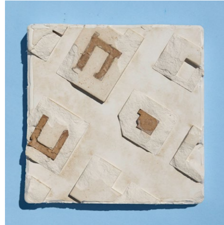
Gips-Test Um zu sehen wie viel Aufwand es wäre haben wir einen Gips Test versucht, das hat aber nicht sehr gut funktioniert.
