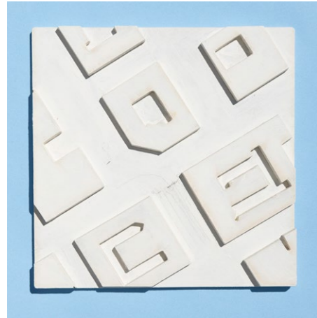
MDF-Test Diese Platte wurde aus MDF gelasert und weiss bemalt, das hat uns gut gefallen.
