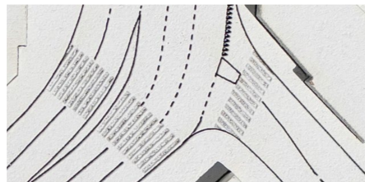
MDF-Gravur-Test Hier haben wir die Fussgängerstreifen graviert, also als fläche ausgelasert. Mit Farbe gespray sah die später so aus.
