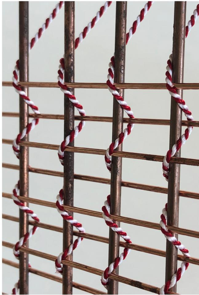
Die Frage, ob die Konstruktionstechnik von Geweben im Architekturbereich eingesetzt werden kann steht hier im Vordergrund. Materialversuche mit Metall und Kunststoff sollen helfen diese Vorstellungen zu entwickeln.
