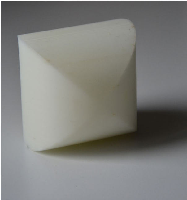
Der Steinmetz-Körper entsteht aus der Schnittmenge zweier Zylindern mit gleichem Durchmesser, welche senkrecht zueinander stehen. Dieser Körper zeichnet sich durch zwei regelmässige Laufrichtungen aus.
